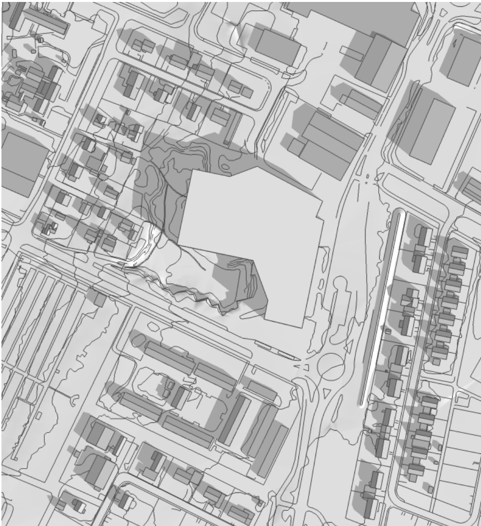
Figur 5 visar maximal skuggningseffekt som skulle kunna inträffa vid 09:00 den 20 mars, vårdagjämning. Byggnation enligt figuren är inte möjlig eftersom byggnationen upptar större yta på marken än 6 400 kvadratmeter.
